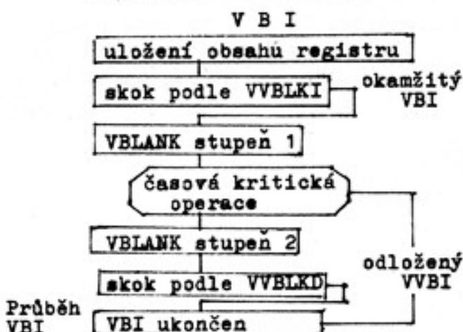
Po spuštění VBI je průběh programu přerušován přechodem do operačního systému. Nejprve se uloží obsah registrů do zásobníkové paměti (stack). Pak následuje skok nepřímo adresovaný vektorem VVBLKI (na adr. 222/223 L/H). Tento vektor ukazuje, pokud ovšem nebyl změněn, na rutinu VBI operačního systému, rozdělenou do dvou stupňů.:
